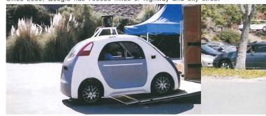
感器和车载电脑上的软件系统来进行操控。它在车顶上的扫描器发射64束激光射线,激光碰到车辆周围的物体,又反射回来,这样就计算出了物体的距离。另一套在底部的系统测量出车辆在三个方向上的加速度、角速度等数据,然后再结合GPS数据计算出车辆的位置,所有这些数据与车载摄像机捕获的图像一起输入计算机,电脑以极高的速度处理这些数据。这突显科技谷歌强大的数据处理能力。
