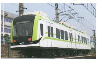
南车株洲机车首列完全超级电容储能100%低地板有轨电车已完成组装,即将开始动态调试。这辆电车采用低底盘设计,地板距地面仅32.5厘米,轨道也采用凹进地下的阴轨,两旁无需站台,方便乘客上下车,同时采用流线型铝合金车身设计,车厢两边设置了大面积玻璃窗,在城市内运行时,将好比是"流动游览车"。这是世界上首次将100%低地板技术与超级电容技术相结合的有轨电车,年底将在广州首个有轨电车项目一海珠示范段上线运营。
