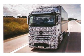
在时速80公里的一辆重型卡车上,驾驶员无需触摸方向盘,卡车就能在前车车速变慢时自动减速并调整方向盘 完成超越。这是发生在德国马格德堡高速公路上的一幕。
