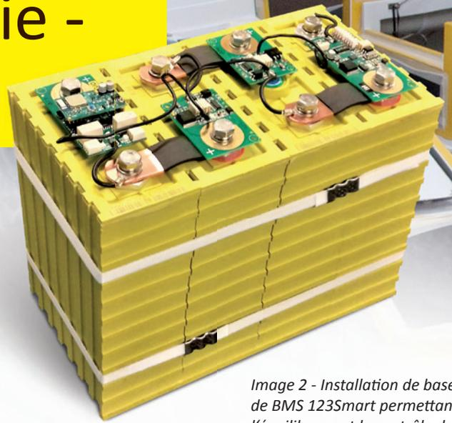
Image 2 - Installation de base de BMS 123Smart permettant l'équilibrage et le contrôle des cellules.
